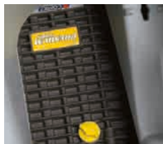
Coffre de rangement avec accès contrôle niveau d'huile de la pompe
