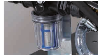
Filtre aspiration (filtre externe à l'entrée de la pompe facilement d'entretien)
